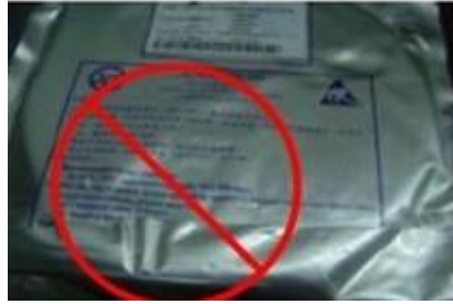
铝箔袋拆封后，采用透明胶带封口
